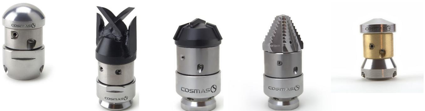
Ugelli caratterizzati da fori posteriori di spinta e da fori laterali di rotazione che consentono una pulizia delle condotte uniforme e completa a 360°. Disponibili con 4 teste intercambiabili da utilizzare a seconda del materiale che si desidera asportare: Testa **Tappo**, Testa **Aggressiva**, Testa **Widia**, Testa **Coltelli**.
