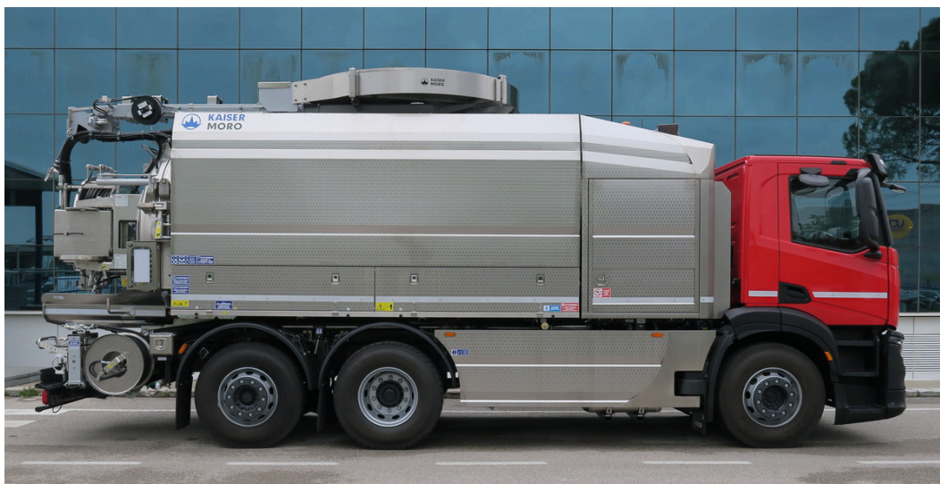
KMO SV-i11 Iveco P.T.T.260 ql. Capacità: 11.400 l fanghi + 5.000 l acqua
