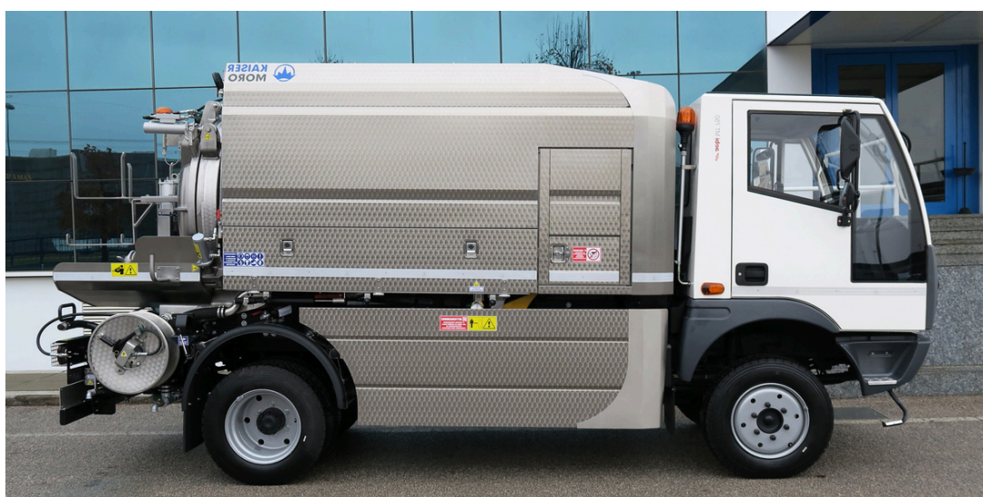
KMO SV-i2 Aebi 4x4 P.T.T.75 q.l. Capacità: 2.400 l fanghi + 1.200 l acqua
