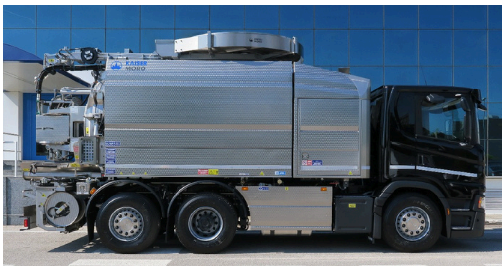
KMO SV-i7 Iveco P.T.T.180 ql. Capacità: 7.000 l fanghi + 3.400 l acqua
