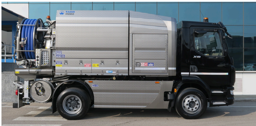
KMO SV-i4 Iveco P.T.T.120 ql. Capacità: 4.000 l fanghi + 2.100 l acqua
