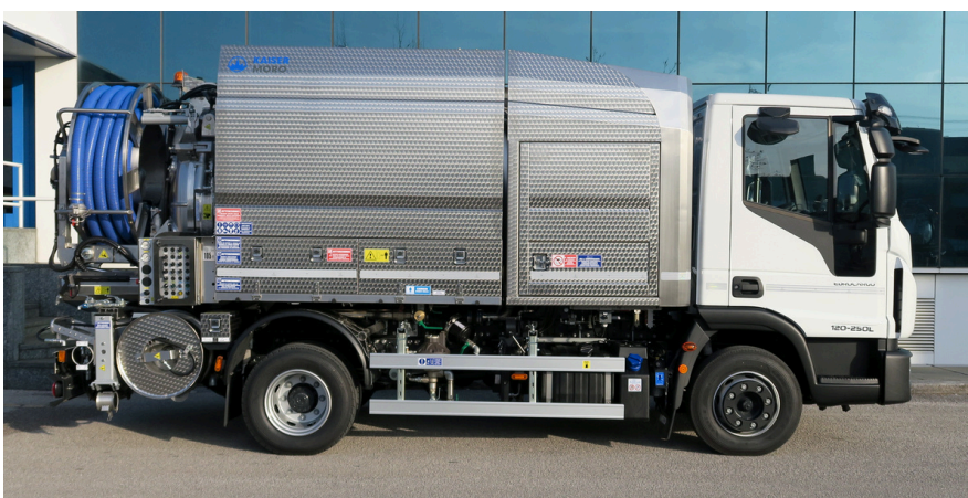
KMO SV-i4 Iveco P.T.T.120 ql. Capacità: 4.300 l fanghi + 2.300 l acqua
