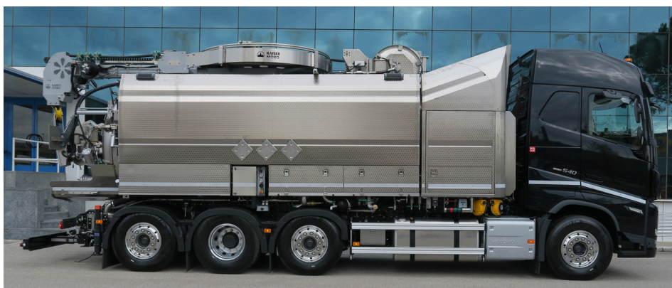
KMO MT-REX Volvo P.T.T.320 q.l. Capacità: 11.000 l fanghi + 4.500 l acqua
