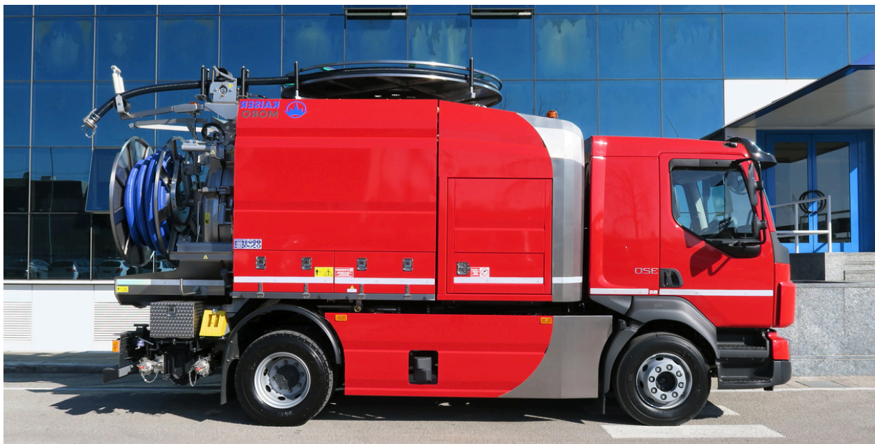
KMO SV-i5 Volvo P.T.T.160 ql. Capacità: 5.200 l fanghi + 2.700 l acqua
