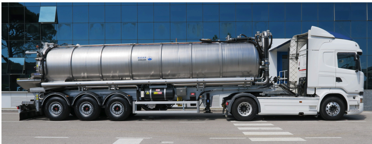
KMO ADRH27SR Scania P.T.T.440 ql. Capacità: 24.000 l fanghi + 3.000 l acqua
