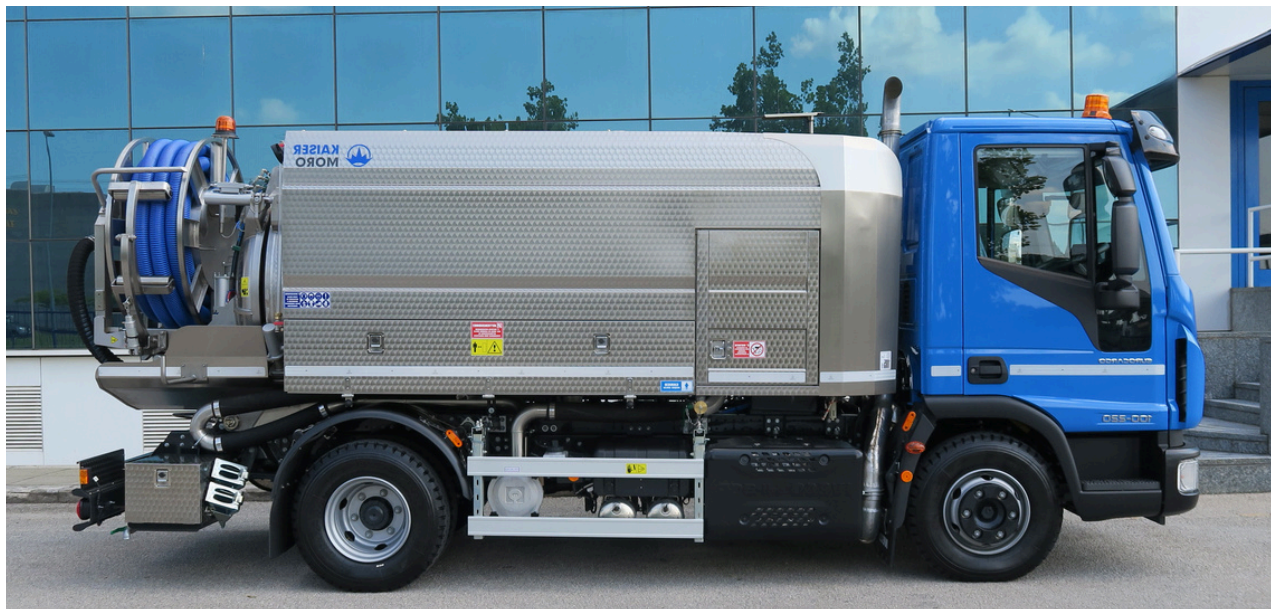
KMO SV-i3 Iveco P.T.T.100 ql. Capacità: 3.000 l fanghi + 1.800 l acqua
