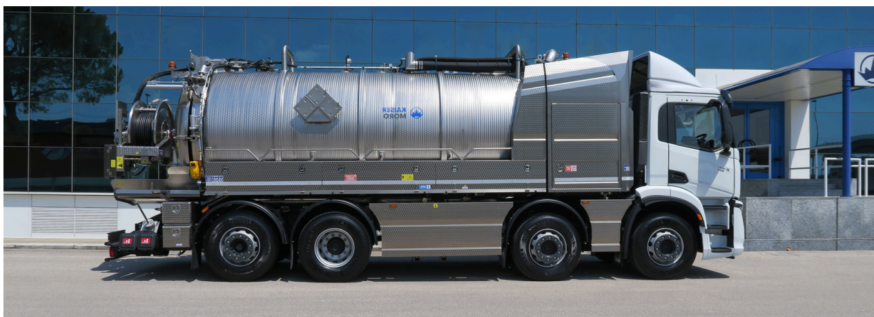
KMO ADRH14 Iveco P.T.T.320 ql. Capacità: 15.500 l fanghi + 3.000 l acqua
