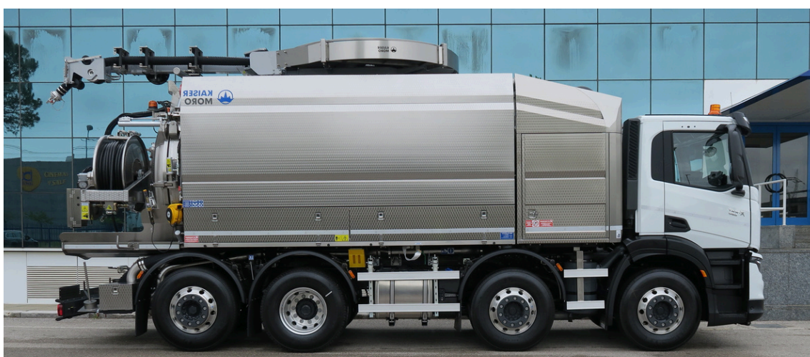
KMO SV-i14 Iveco P.T.T.320 q.l. Capacità: 14.200 l fanghi + 4.400 l acqua
