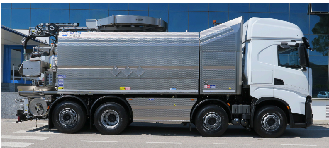
KMO SV-i14 Iveco P.T.T.320 q.l. Capacità: 14.200 l fanghi + 5.100 l acqua
