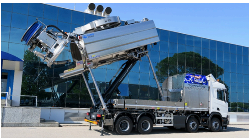
KMO MT-REX Volvo P.T.T.320 q.l. Capacità: 11.000 l fanghi + 4.500 l acqua
