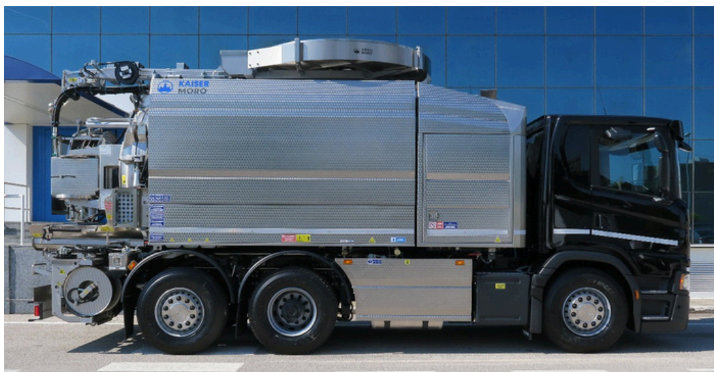
KMO SV-i10 (p.corto) Scania P.T.T.260 ql. Capacità: 10.500 l fanghi + 3.600 l acqua
