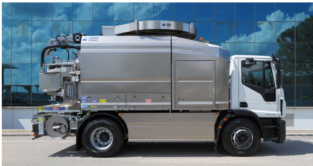
KMO SV-i7 Iveco P.T.T.180 ql. Capacità: 7.000 l fanghi + 3.400 l acqua
